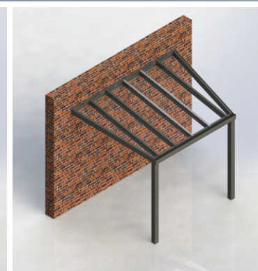
Pulldach mit schräg hochlaufenden Trägern
